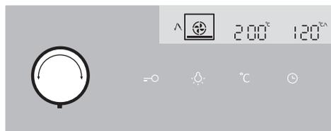
**3** Otočte KNOFLÍKEM VOLBY SYSTÉMU PEČENÍ (horký vzduch a spodní topný článek). Zobrazí se symbol, předem nastavená teplota a teplota sondy. Stiskněte tlačítko START.
